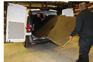
Stap 5 Positioneer de vloer voorin bij de tussenwand en laat hem aan de achterkant zakken
