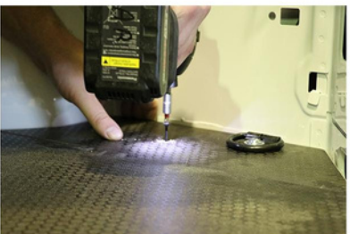
Stap 11 Schroef de vloer op alle voorgeboorde punten vast.
