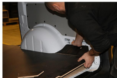
Stap 8 Plaats de lamello's in de daarvoor bestemde groeven in de flap. Plaats vervolgens de flap in de daarvoor bestemde groeven in de vloer.
