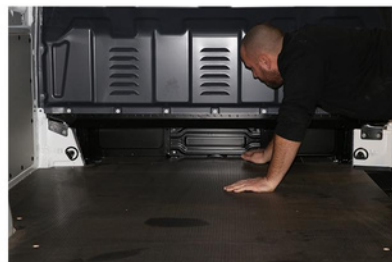
Stap 7 Druk de vloer zo nodig in positie
