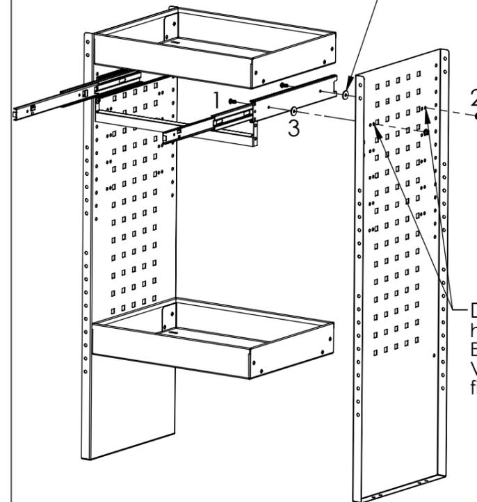
D4. Schrauben Sie den Verlängerungsschieber in die hinteren Löcher am Giebel. Es erfordert das Extrudieren des Verlängerungsschlittens, um das passende Loch zu finden, in welchem Sie die Schraube einsetzen.
