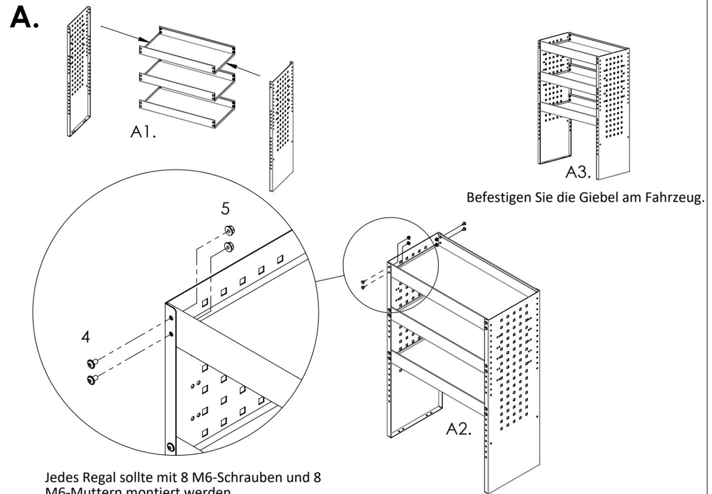
Jedes Regal sollte mit 8 M6-Schrauben und 8 M6-Muttern montiert werden.
