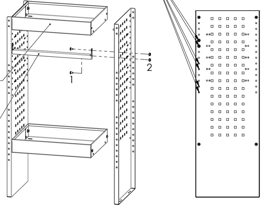
D3. Legen Sie eine Unterlegscheibe zwischen Giebel und Verlängerungsschieber.
