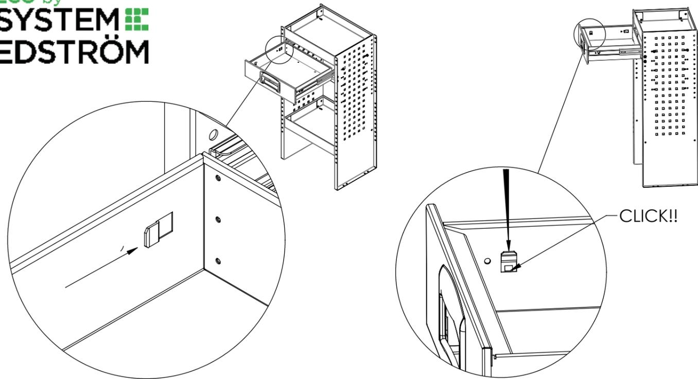
D5. Um die Schublade zu verlängern, schieben Sie das hintere Bajonett bis zur Vorderseite der entsprechenden Bohrung der Schublade.
