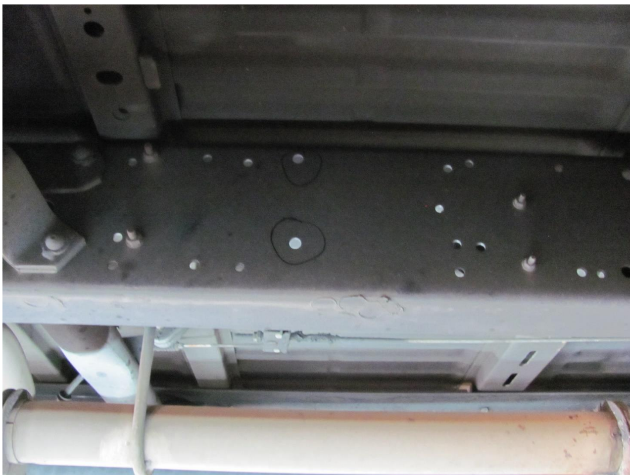
Position de montage côté arrière-droit, boulon M8
