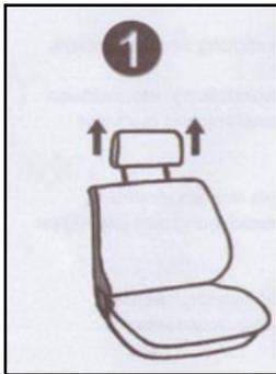
Entfernen Sie die Kopfstütze
