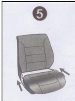
Ziehen Sie den Sitzbezug von vorne nach hinten auf die Sitzfläche. Auch hier muss die Lasche zwischen Rücklehne und Sitzbezug durchgezogen werden. An der Rückseite befinden sich Gummischlaufen mit Metallhaken. Belasten Sie diese nicht zu stark. Sie dienen ausschließlich dazu den Sitzbezug am Platz zu halten
